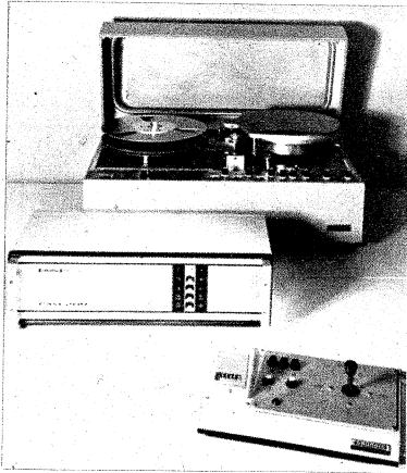
Bild 12. Grundig-Videorecorder BK 200 mit nach dem FAM-System arbeitenden Farbzusatzgerät, dem ein Pal-Codier- oder Decodiereinsatz beige-fügt werden kann. Vorn das Pult für die Fernsteuerung aller wichtigen Funktion
