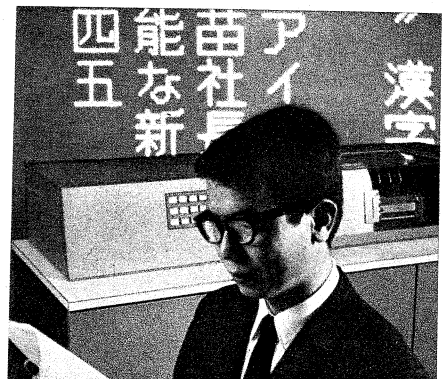
Der Kanji-Drucker arbeitet zusammen mit dem IBM-System /360
